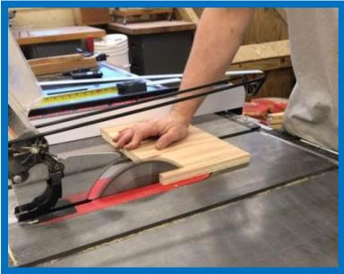
*La lame ne doit pas être beaucoup plus haute que le bois. Vous pouvez ajuster la hauteur de la lame si elle est trop basse ou trop haute.*
