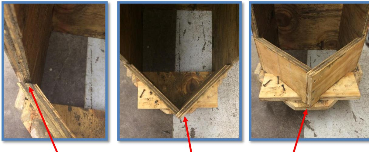
*CI-DESSUS: Le bord pointu de la partie UV doit affleurer les parties C/D. La pointe de la partie UV ne doit pas dépasser l'extrémité de la partie S ou T. La lumière ne doit pas passer lorsque l'on regarde le montage.*
