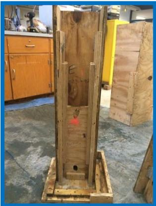
*Vue de côté de la planche de maintien orientée vers le bas AVANT que le moule soit retourné.*
