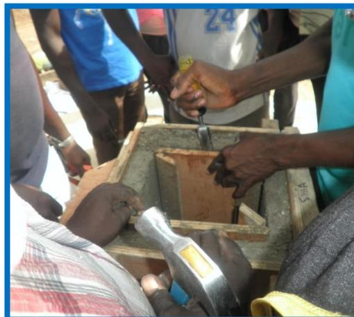
Vous pouvez utiliser un marteau et un matériel de support pour extraire les pièces E/F et/ou utiliser un burin pour décoller les pièces du béton.
