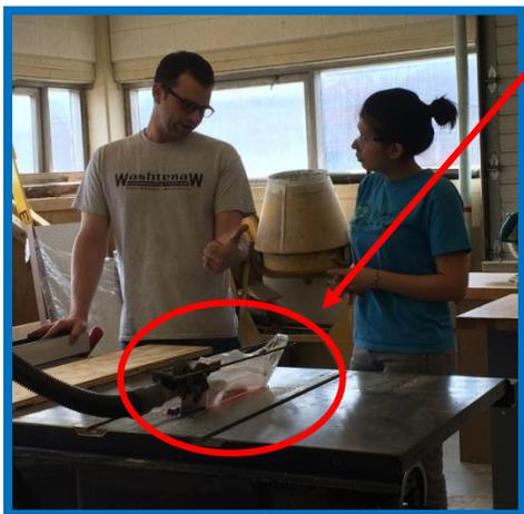
*Si possible, utilisez une scie sur table dont le dispositif de sécurité est déjà en place.*
