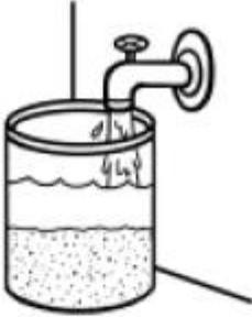
1. Mettez un peu de sable de filtration tamisé dans un seau. C'est du sable passé dans le tamis de 0,7 mm.
