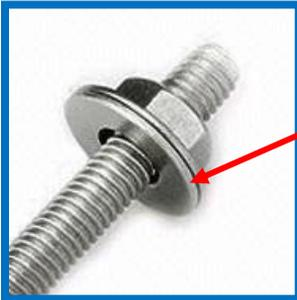
*Si possible, nous recommandons deux rondelles pas boulon pour une meilleure durée de vie. Nous recommandons de placer une rondelle entre la tête du boulon et le matériel de support et la deuxième entre l'écrou et le matériel de support.*
