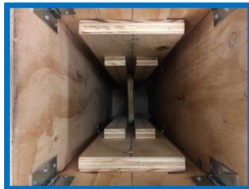
*Vue du dessus de la planche de maintien orientée vers le bas AVANT que le moule soit retourné.*
