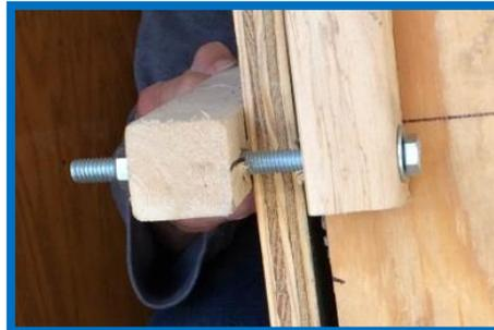
*Les rondelles sont utilisées pour protéger le matériel de support de la tête du boulon. Cela permet d'augmenter la durée de vie de votre moule.*
