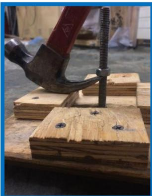
*Assurez-vous que l'écrou n'est PAS complètement vissé. Il doit être placé au milieu pour pouvoir extraire le couvercle lors du démoulage.*
