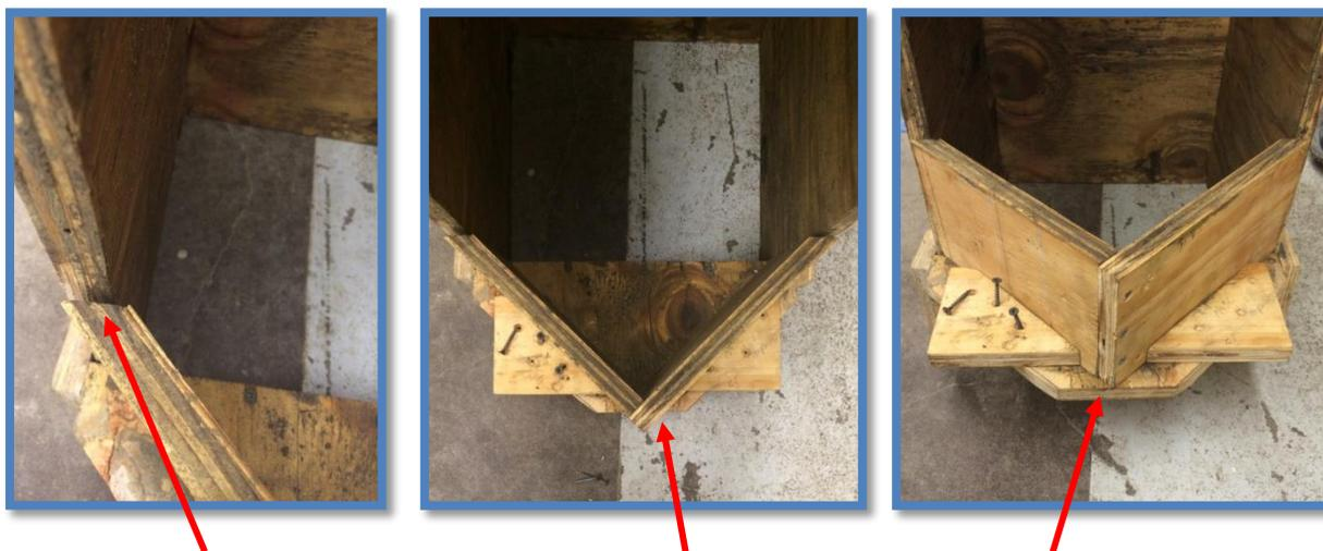
*ACIMA: As beiradas anguladas das peças UV devem estar niveladas com as Peças C/D. A parte pontuda da peça UV não deve ir além da beirada da Peça S ou T. Não deve ter nenhuma luz visível quando estiver olhando para as peças.*
