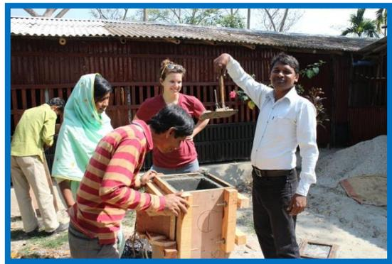
*A Tampa irá sair se o martelo for usado corretamente como uma alavanca.*
