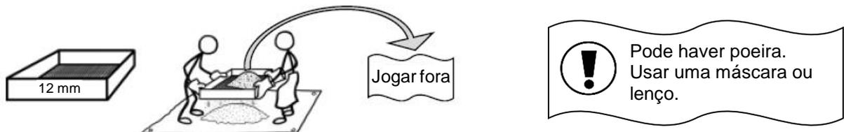
2. Coletar todo o material que passou pela peneira de 12 mm. Colocar em uma peneira de 6 mm (1/4"). **Guardar todo cascalho que ficar em cima da peneira de 6 mm na pilha de estoque de cascalho de 6-12 mm.** Esta pilha será usada para duas coisas: o cascalho grosso para quando fizer o concreto e o cascalho de drenagem que vai dentro do filtro.
