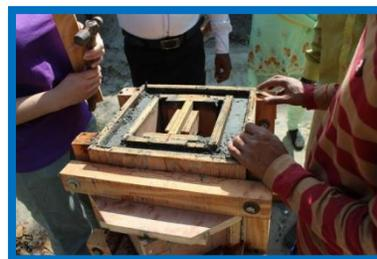
*Depois de virar o Molde para desenformar, a Tábua Central estará virada para o topo, facilitando a sua remoção.*
