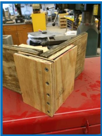
*Usando as peças de sobra (peças marcadas com SC) dos cortes iniciais, você pode adicionar suporte extra ao Bico, como mostrado, se ele começar a desmontar.*
