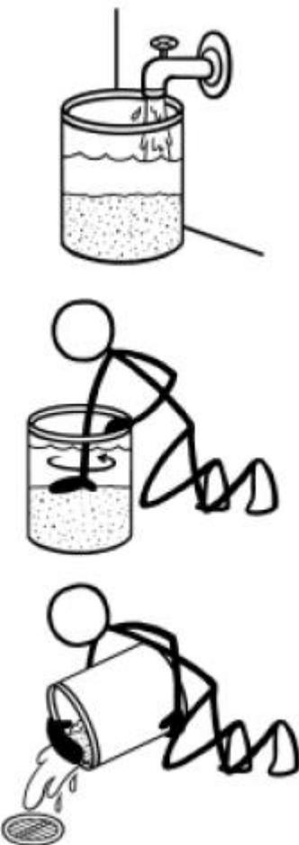
1. Colocar uma parte da areia de filtragem em um balde. Essa areia passou pela peneira de 0,7 mm (0,03")
