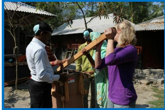
*Usar a madeira como alavanca para levantar a Tábua Central para cima do Núcleo Central.*
