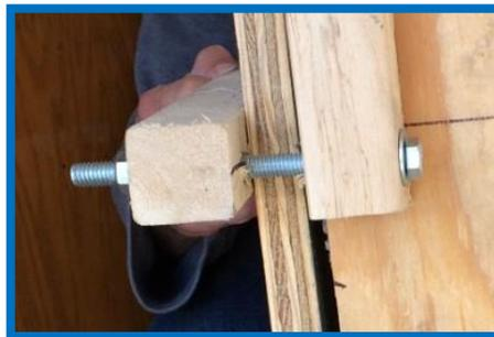
*As arruelas são usadas para proteger o material de suporte da cabeça dos parafusos. Usar elas irá aumentar a vida útil do seu Molde.*
