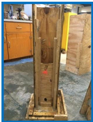
*Vista lateral da Tábua Central colocada em direção da base do Molde. ANTES de virar.*
