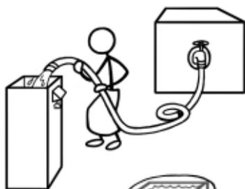
7. Encher o filtro até o topo com água. Cobrir o filtro com um pano, lona ou folha plástica.
