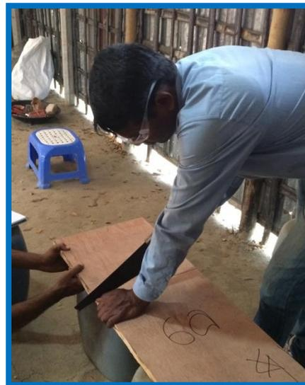
Fazer alguns golpes devagar com a serra para começar o corte. Uma vez que esse corte tenha sido iniciado, mover a sua mão guia para longe da lâmina. Quando estiver cortando, segure a lâmina a um ângulo de 45 graus e mantenha os cotovelos perto do corpo para evitar que a lâmina dobre.
