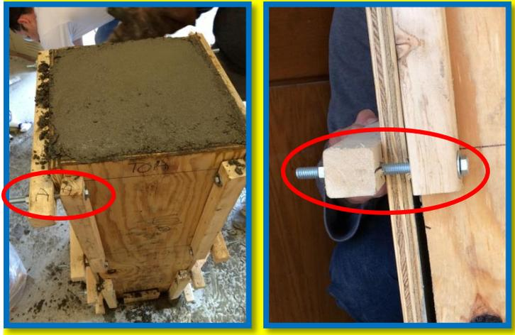
*Os parafusos ajudam a manter a parte externa do Molde unida quando o concreto estiver curando.*
